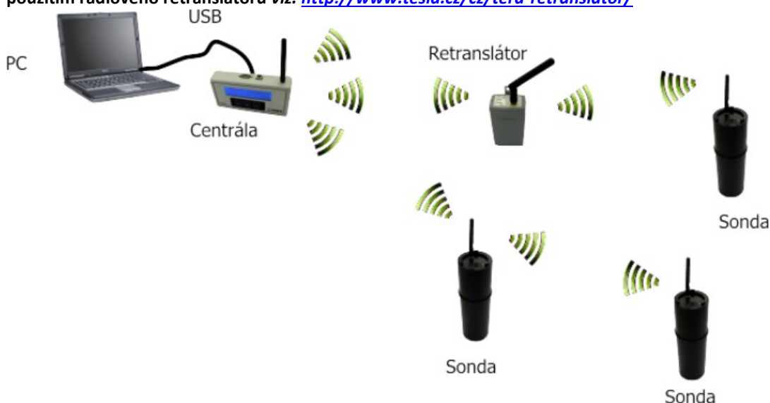
Obrázek 1 - Zapojení centrální jednotky TCR3 v měřícím systému TERA
